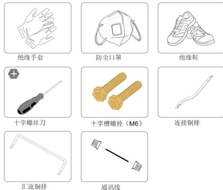
步骤 1：连接铜排前，穿好绝缘鞋和绝缘手套，在连接包之间的铜排之前，请先断开包与开关柜之间的电缆。
