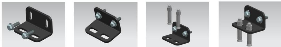
步骤 1：将 L 型角钢先与柜体使用 M10\*25 外六角三组合螺丝固定，扭力（20 N·m）。
