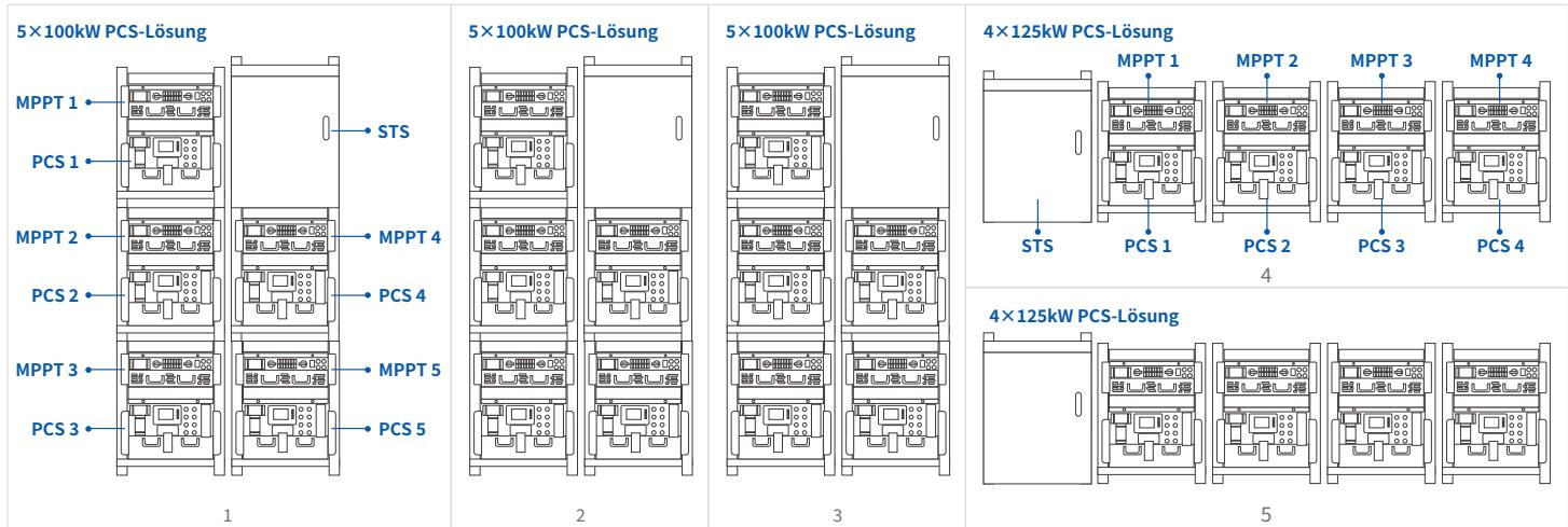
Fünf STS-Module können parallel Unterstützung für fünfundzwanzig 100-kW-PCS-Module oder zwanzig 125-kW-PCS-Module bereitstellen und bilden so ein 2,5-MW-System.
