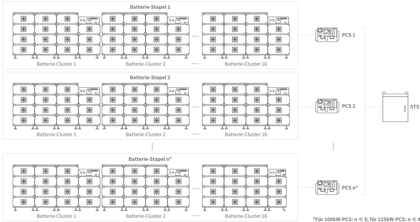
Ein STS-Modul kann für den Parallelbetrieb an fünf 100kW PCS-Module oder vier 125kW PCS-Module angeschlossen werden.
