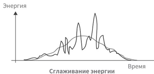
3. Используется для сглаживания пиков и регулирования частоты на стороне генерации электроэнергии
