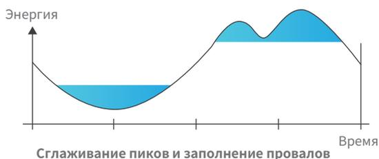
2. Интегрируется с системами накопления возобновляемой энергии для сглаживания выходной мощности
