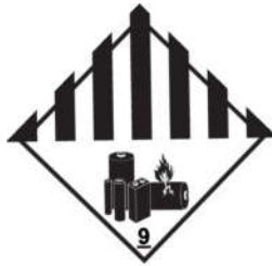
Kennzeichnung „Sonstige gefährliche Stoffe Klasse 9“ und UN-Kennzeichnung
