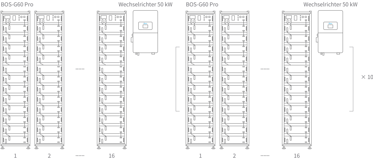
Unterstützt maximal 16 parallel geschaltete Batterieracks
